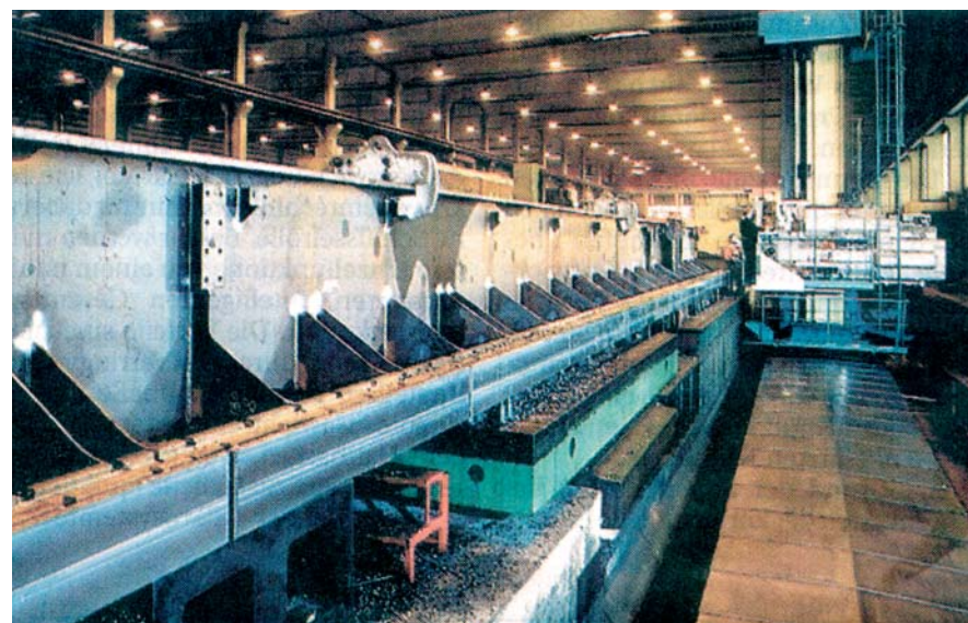
24 Weichensegmente à 26 m Länge mussten oben und seitlich auf Maß gefräst werden. Mit einem CNC-Bearbeitungszentrum (Foto) wurden anschließend die Nutenführungen sowie die Bohrungen zur kraftschlüssigen Befestigung der Statorblöcke und für den Verbindungsstoß an den Trägerenden hergestellt.
